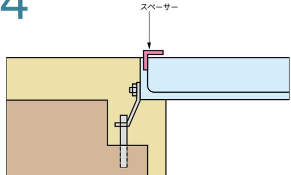
仕上モルタルを充填します。その際、枠が押されないようスペーサーを入れてください。内枠にモルタルを入れる際も同様に行ってください。
