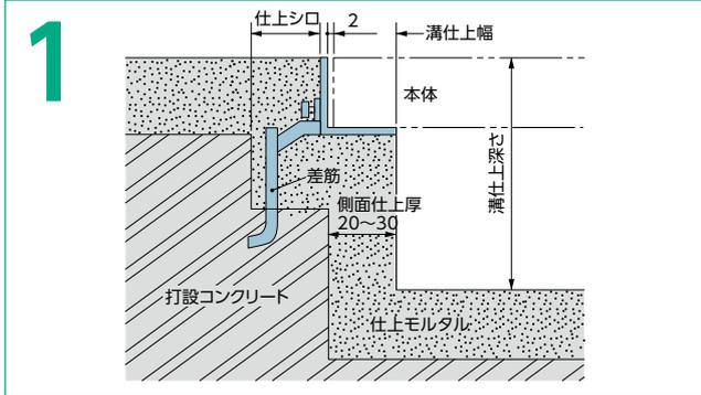
受枠のスペース・仕上シロを考慮して型枠を作り、コンクリートを打設します。
