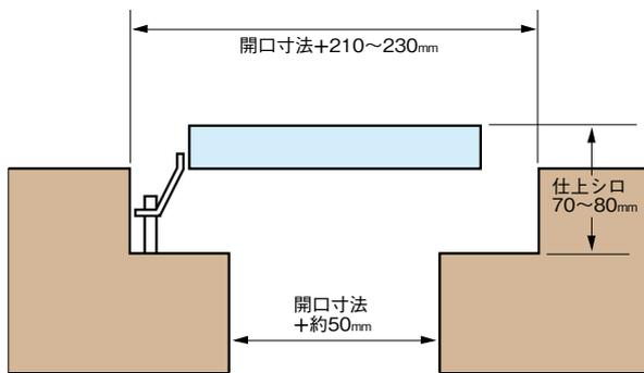
仕上がりシロ・受枠の取り付けを考慮して型枠を作り、コンクリートを打設します。
