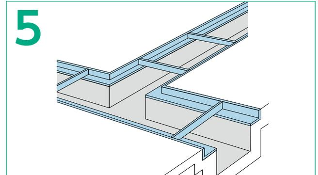
モルタルを充填して受枠を固定します。
