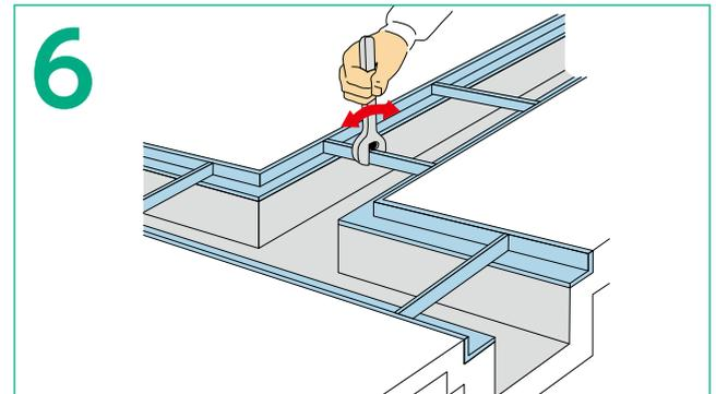
モルタルの乾燥後、幅ギメ材をモンキーレンチなどではさみ、前後に動かして外します。ハンマー等で叩いて外すのは避けてください。
