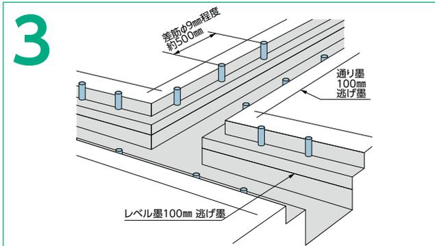
受枠を確実に取り付けするため、通り墨・レベル墨は100mm逃げ墨とし、正確な墨出しを行います。
