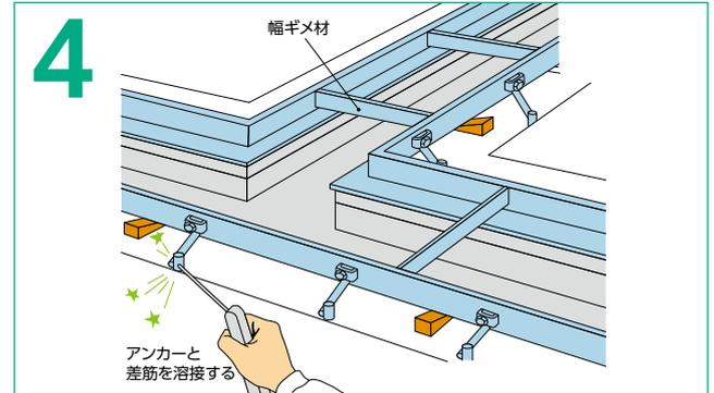
レベルゲージと水準器を併用して受枠の平行・水平・ねじれに注意の上、正確に保持し、アンカーを差筋に確実に溶接して固定します。(幅ギメ材は受枠に仮固定してあります。)
