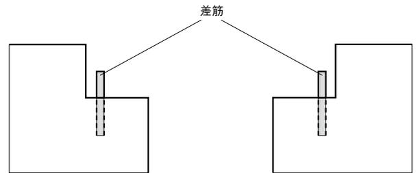
受枠のアンカー位置に合わせて差筋を打ち込みます。
