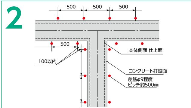
受枠支持用の差筋は9mm程度を使用し、500mmピッチで取り付けます。コーナー部分には、コンクリート打設面より100mm以内に必ず1ヶ所取り付けます。
