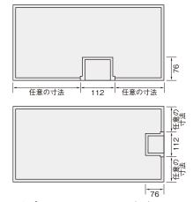
注)YMSTD-1・YMSTC-1・YMSTD-3・YMSTC-3 使用時の通線プレートの取付けは幅 (W) 方向のみ可能です。
